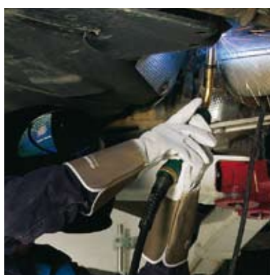
Trimning af svejseparametre direkte fra Dialog brænder
