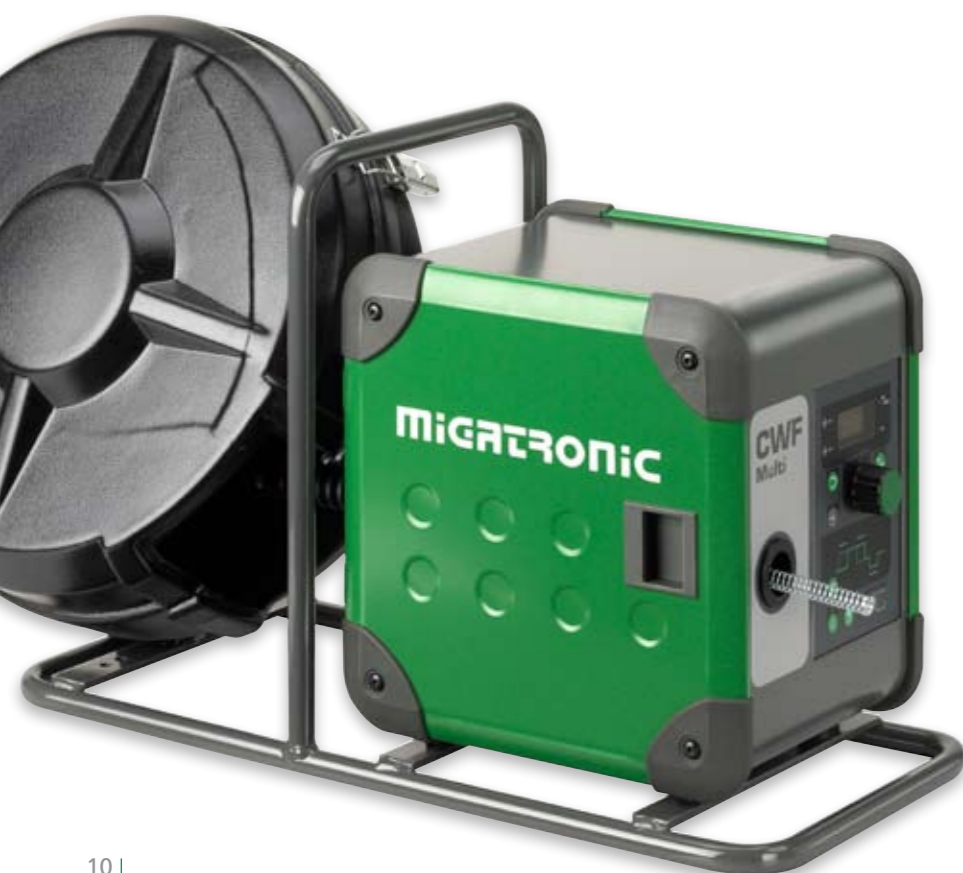
CWF Multi har trinløs regulering af trådhastighed fra 0,2 til 5,0 m/min.
