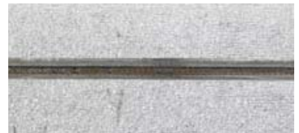
Galvaniseret sort stål – Plasma-smelte i 0,5 mm godstykkelse
