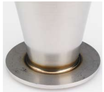
Kegleformet rør TIG svejst til plade. Bemærk det lille A-mål
