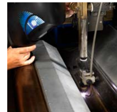
Plasma i langsømsautomat - rustfaste svøb
