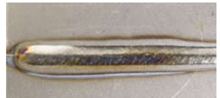
Rustfast stål – Plasma-keyhole i 6 mm godstykkelse
